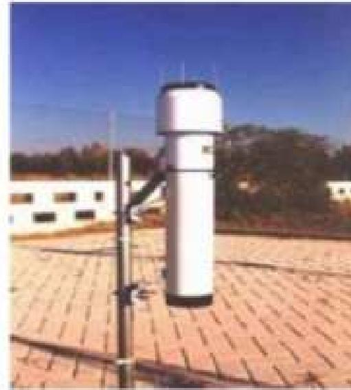
Los pluviómetros lectura directa tienen un recipiente y un embudo. Cada 12 horas se vacía el recipiente en una probeta graduada con una sección diez veces menor que la de recepción, con lo que es posible establecer una relación entre la altura en la probeta y la precipitación en milímetros por metro cuadrado.
